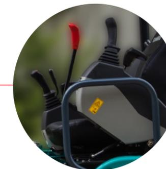
**Interruttore di sicurezza per il controllo del pilotaggio**
