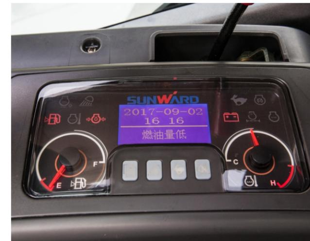
La strumentazione LED di alta fascia non solo mostra la data, le ore di lavoro, il livello dell'olio e la temperatura dell'acqua, ma integra anche le funzioni di azionamento marcia lenta/veloce, l'interruttore delle luci di lavoro e mostra alcune anomalie presenti.
